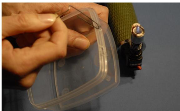
*Figure 1: Percement de la bordure du récipient en plastique avec la pointe du trombone chauffé.*
