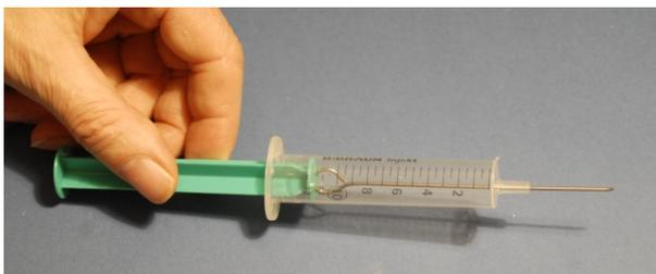
*Figure 3: Fixation de la broche de la tige métallique dans la seringue.*
