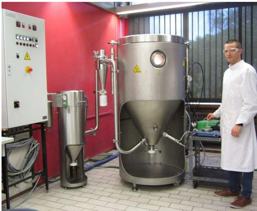
*Fig.2 : Spray-dryer (« atomiseur » en français) permettant le séchage de solutions ou de suspensions jusqu'à 5 litres par heure. La technique de spray-drying possède de nombreux atouts en termes de simplicité, de reproductibilité et de possibilité de transfert industriel et s'applique aussi bien aux poudres inorganiques (par ex. matériaux d'électrodes de batterie) qu'aux poudres pharmaceutiques.*
