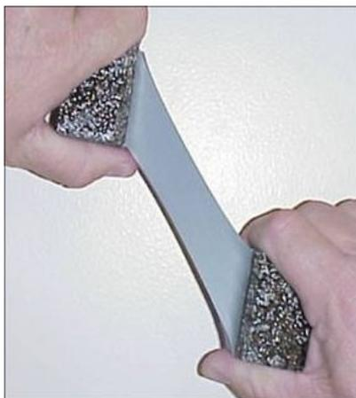
Mastic d'étanchéité silicone pour les joints dans les façades en béton ou en verre. Mastic mono-composant de type « alkoxy » qui réticule à température ambiante par diffusion de l'humidité de l'air et réaction de condensation.
