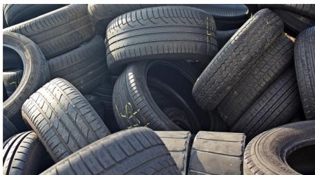
Les pneus sont fabriqués pour la partie élastomère à partir de dérivés du pétrole qui sont additionnés avec du carbone et autres additifs, ensuite réticulés et mis en forme avec des « cords » de Beckaert, qui constituent l'âme résistante.
