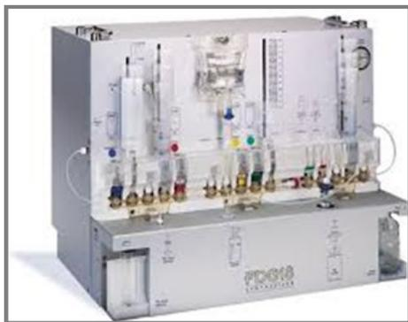
*TRACERlab MX – Premier synthétiseur commercial (GE Healthcare) dit « cassette-based », permettant donc de produire beaucoup plus facilement et industriellement (càd à fréquence et rendements élevés) des radiotraceurs simples marqués au Fluor-18 en conformité avec les règles de bonnes pratiques de fabrication exigées par les agences*
