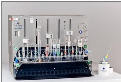
*de pression pour une entrée d'azote, deux fours, une pompe HPLC quaternaire avec détection UV et radiochimique, jusqu'à 4 colonnes HPLC pour de la purification préparative avec un système de collecte automatique des fractions d'intérêt.*
