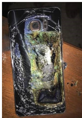
Thermal « runaway » d'une batterie à électrolyte liquide
