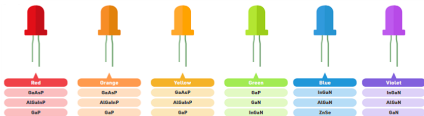
Différentes couleurs obtenues avec différents semi-conducteurs (adapté de la réf. 1).
